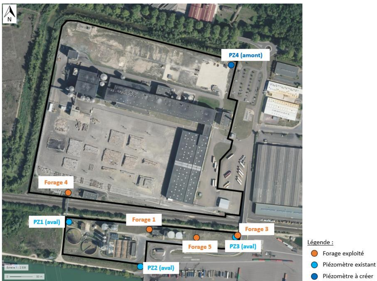
Figure 16 : Localisation des forages et piézomètres du site
